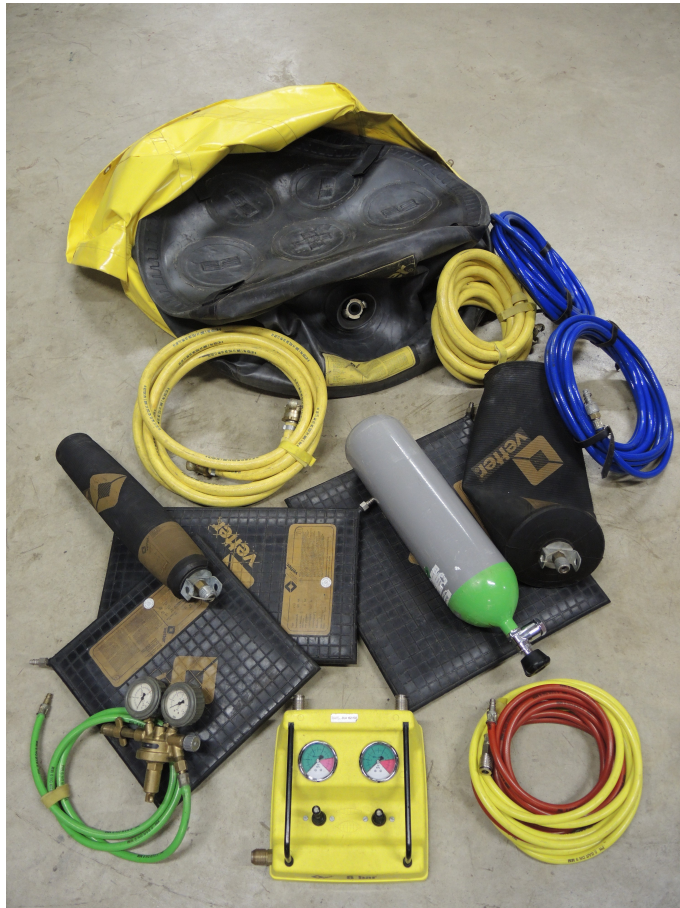
Niederdruckhebekissen ( 1 bar Arbeitsdruck ) + Hochdruckhebekissen ( 8 bar Arbeitsdruck )
